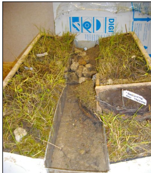
Les maquettes réalisées par les agents du Syndicat et qui représentent un cours d'eau en bon état (gauche) et recalibré (droite)
