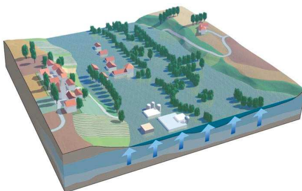
Remontée de nappe
